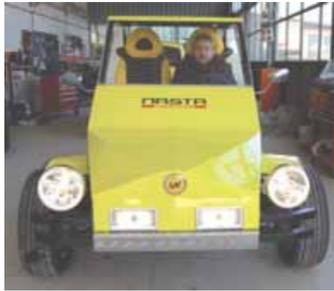
Attraverso un'elettrovalvola è possibile azionare un silenziatore di scarico o disinserirlo aumentando i cavalli di potenza. **Qual è stata la maggiore difficoltà nella costruzione?** L'avantreno anteriore. Davanti era troppo leggera, si è reso necessario bilanciare la sospensione; alla fine il risultato è stato eccellente.
